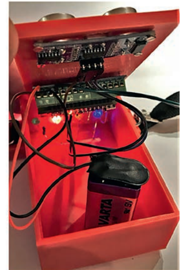
Abb. 2: Aufbau der Elektronik in der mobilen Sensoreinheit, links ist der prinzipielle Aufbau auf einer Steckplatine gezeigt und rechts ein Foto in kompakter Form im Sensor-Gehäuse.
