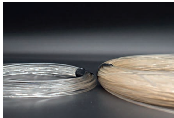
Abb. 2: Vergleich des Filaments nach einem (links) und nach fünf (rechts) Recycling-Zyklen zur Veranschaulichung der Polymerdegradation.
